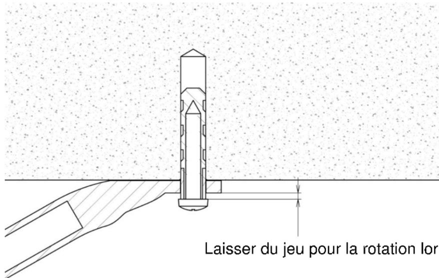
Refermer le volet manuellement et effectuer un réglage fin en desserrant la vis sans tête puis resserrer.
