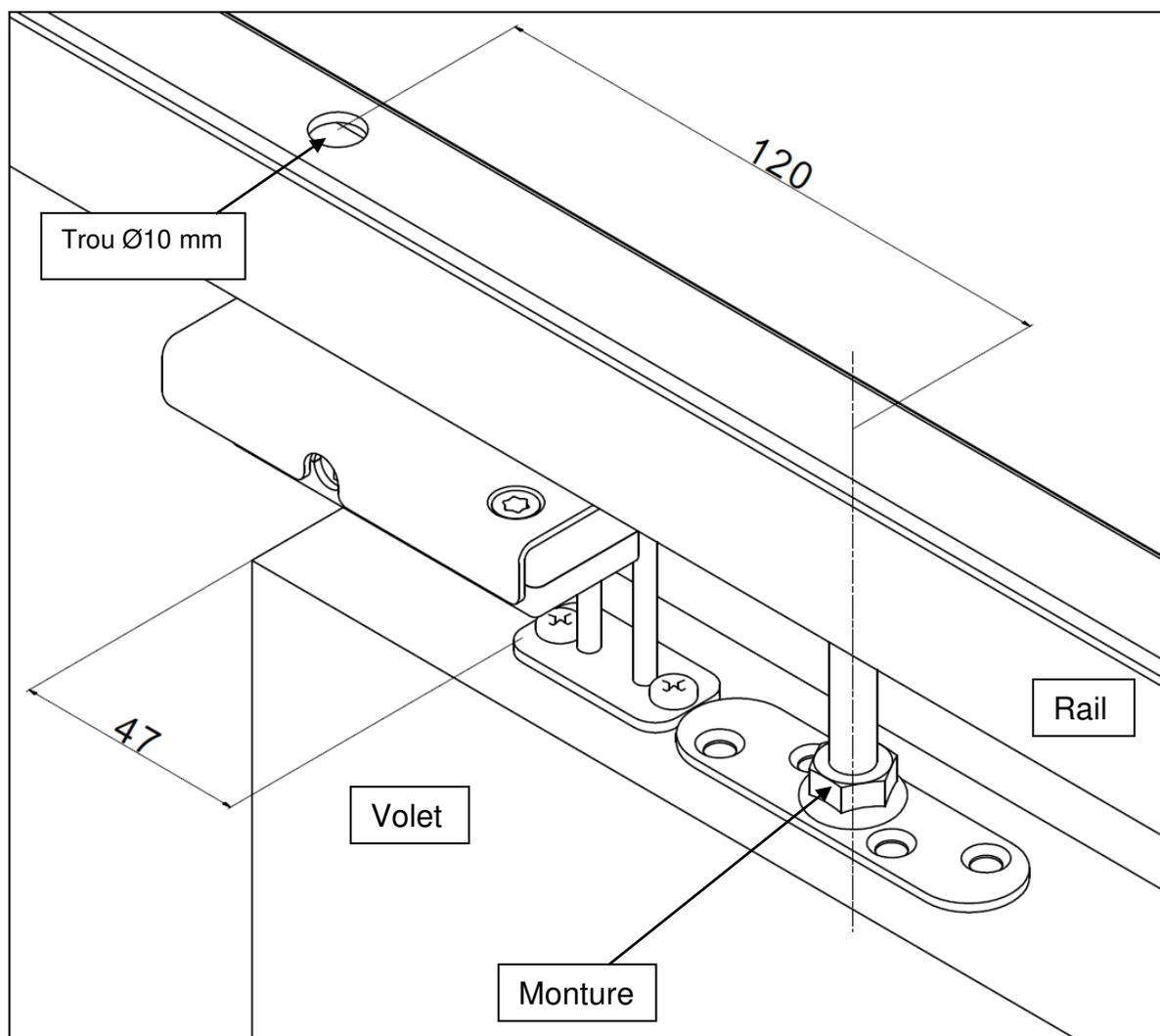
Monter le crochet de verrouillage à 47 mm du bord du volet et centré à la monture.
