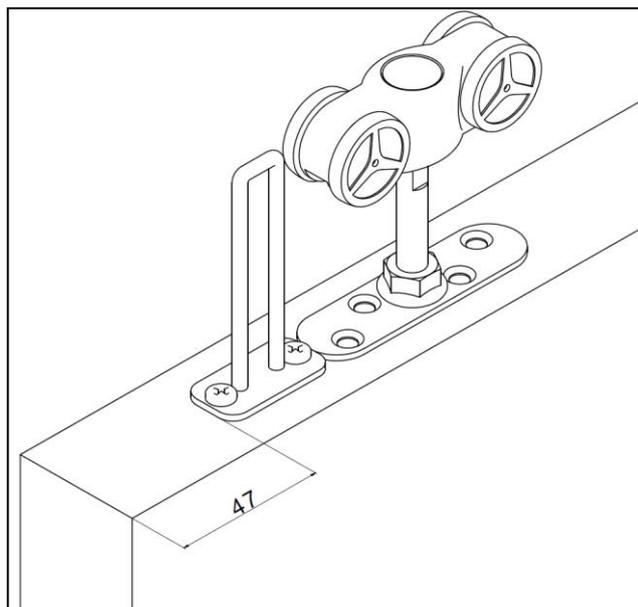
Introduire l'écrou de la gâche dans le rail. Attention au sens de montage de l'écrou.
