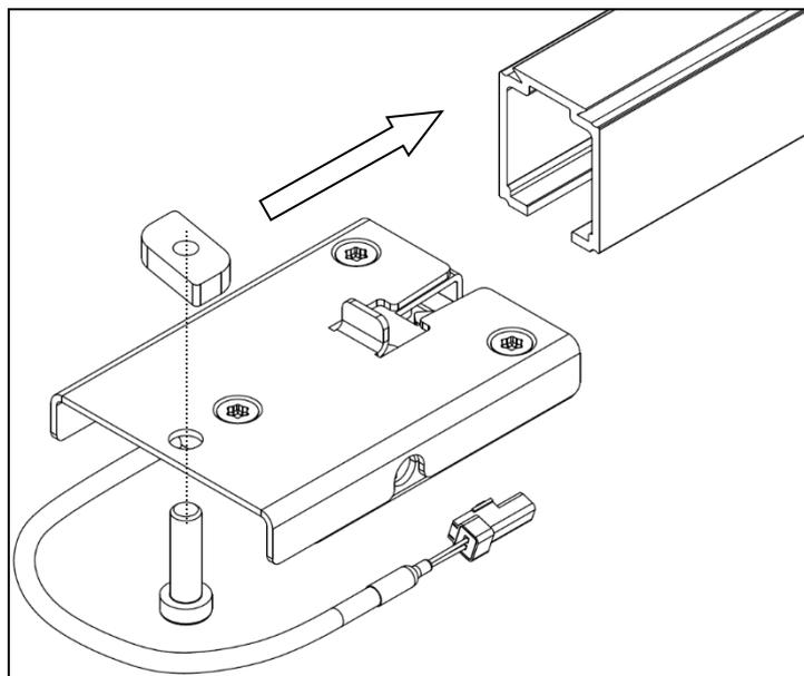
Positionner le volet en position fermé. Faire glisser la gâche dans le rail jusqu'à ce qu'elle se verrouille.
